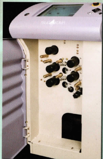
圧力制御機器の上方配置
